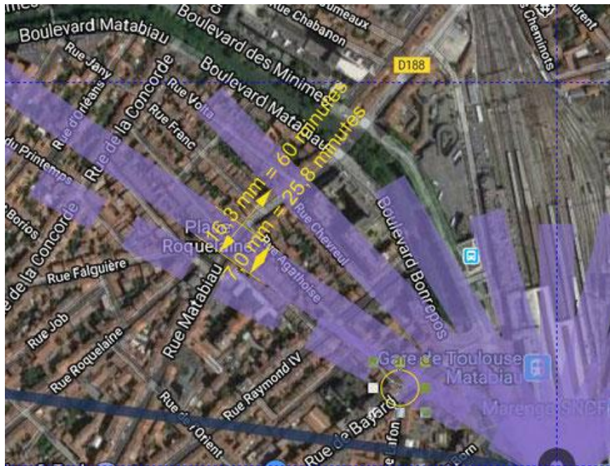
Résultat de simulation (association Chalets-Roquelaine) / Projection le 15 janvier 2020, du lever au coucher du soleil. (Place Roquelaine 15 janvier 2020 à 9h00 : durée de l'ombre : 25,8 minutes. Plus proche de la tour, le carrefour Bayard/Agathoise – cerclé - devrait rester dans l'ombre plus d'1 heure)
